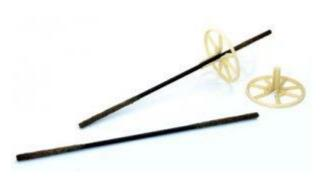
того, чтобы вырвать гибкую связь для кирпичной кладки гален из бетонного раствора марки М100, следует приложить значительное усилие в 4000 Н. Относительная деформация стержней из базальтопластика при разрыве составляет всего 30%, а коэффициент теплопроводности доходит до 0,46 Вт/м\*
